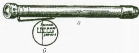
Л. 34.6. Індивідуальний дозиметр ДКП 50-А: а — зовнішній вигляд; б — шкала
