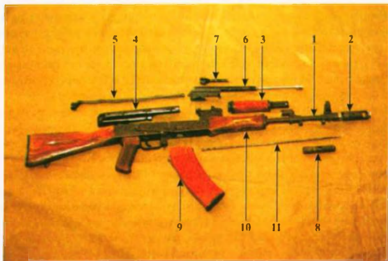
Іл. 12.2. Основні частини й механізми автомата і його приладдя: 1 — ствол зі ствольною коробкою, ударно-спусковим механізмом, прицільним пристроєм, прикладом і рукояткою; 2 — циліндр газово-компенсатор; 3 — газова трубка зі ствольною накладкою; 4 — кришка ствольної коробки; 5 — зворотний механізм; 6 — затворна рама зі штовхачем (газовим поршнем); 7 — затвор; 8 — пінат з приладдям; 9 — магазин; 10 — цівка; 11 — шомпол
