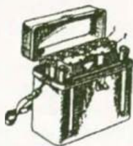
Іл. 34.7. Комплект ІД-1: 1 — індивідуальний дозиметр; 2 — зарядний пристрій
