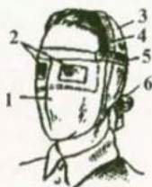
Іл. 36.1. Протипилова тканинна маска ІТМ-1: 1 — корпус маски; 2 — оглядові отвори; 3 — кріплення; 4 — гумова тасьма; 5 — поперечна гумова смужка; 6 — зав'язки
