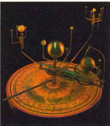
Рис. 3.8. Механічний прилад XIX ст., який демонстрував рух планет і зміну пір року на Землі
